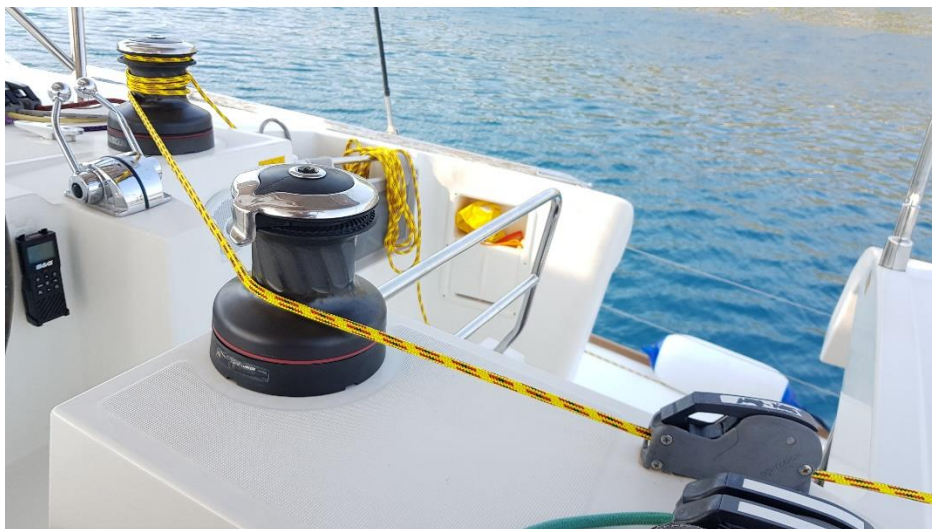
Zdjęcie 14. Prowadzenie fału foka przy jego zwijaniu (zrzucaniu).
