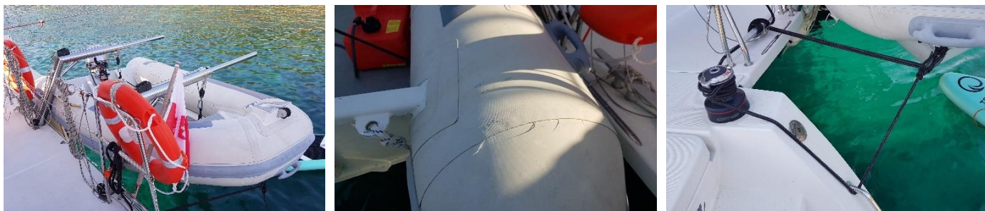
Zdjęcie 8. Mocowanie pontonu do przewożenia na jachcie.
