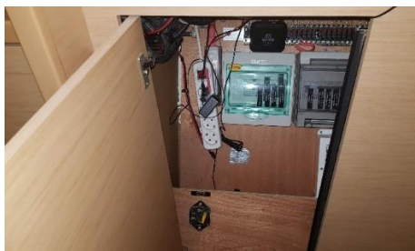
Zdjęcie 24. Pod prawą koją rufową: bezpieczniki od kotwicy oraz dodatkowo heble od odłączania akumulatorów serwisowego i prawego silnika. Za panelem 12/220V w salonie: bezpieczniki 12V (czerwone) i główne (szara skrzynka) instalacji 220V.
