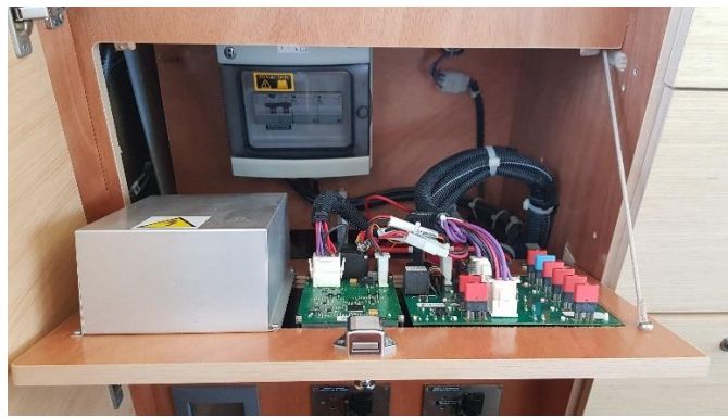
Zdjęcie 24. Pod prawą koją rufową: bezpieczniki od kotwicy oraz dodatkowo heble od odłączania akumulatorów serwisowego i prawego silnika. Za panelem 12/220V w salonie: bezpieczniki 12V (czerwone) i główne (szara skrzynka) instalacji 220V.
