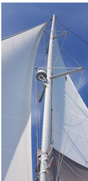
Zdjęcie 13. Fok oraz roler foka przy zwiniętym foku (mało linki na bębnie oznacza, że żagiel jest rozwinięty - postawiony).
