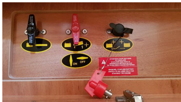
Zdjęcie 26. Kabina lewa rufowa, pod koją przy podłodze: hebel (czerwony kluczyk) do awaryjnego równoległego podłączenia akumulatorów rozruchowych silników z akumulatorami serwisowymi. Odłączanie akumulatora rozruchowego lewego silnika.
