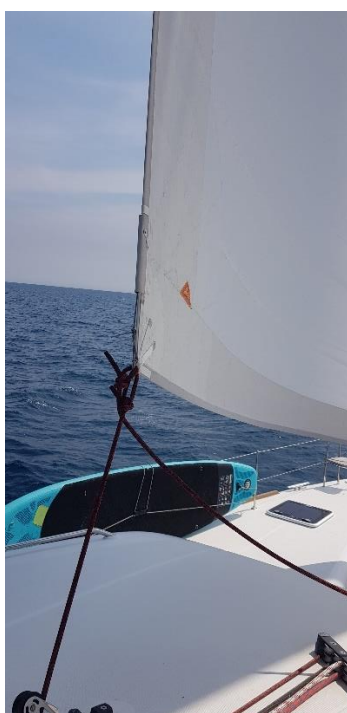
Zdjęcie 13. Fok oraz roler foka przy zwiniętym foku (mało linki na bębnie oznacza, że żagiel jest rozwinięty - postawiony).
