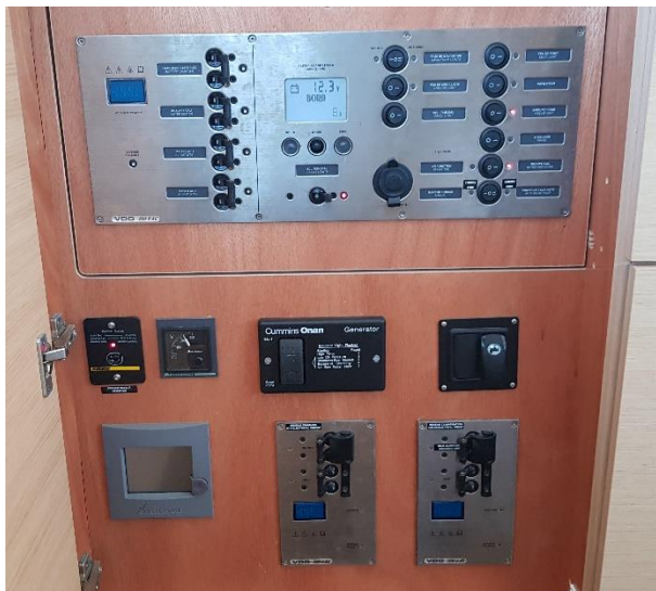
Zdjęcie 22. Tablica rozdzielcza instalacji 12 V i 220 V.
