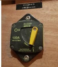
Zdjęcie 25. W szafce w prawej kabinie rufowej bezpieczniki od lewej: w pierwszej puszcze: generator, odsalarka, zmywarka, wolny (opisany jako kostkarka do lodu), w prawej puszcze: różne strefy klimatyzacji. Poniżej puszek (żółty przełącznik) – kabestan elektryczny.
