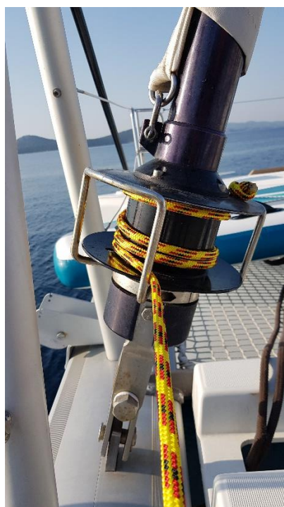
Zdjęcie 13. Fok oraz roler foka przy zwiniętym foku (mało linki na bębnie oznacza, że żagiel jest rozwinięty - postawiony).
