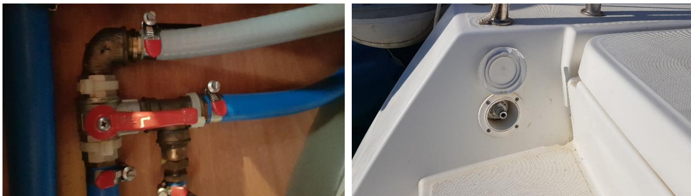
Zdjęcie 33. Przetłacznik pomiędzy zbiornikami wody pitnej, w pozycji zbiornik 1 – lewa burta, w szafce w kabinie rufowej lewej oraz złącze do węży podłączającego katamaran do stałego dopływu wody użytkowej z kei.
