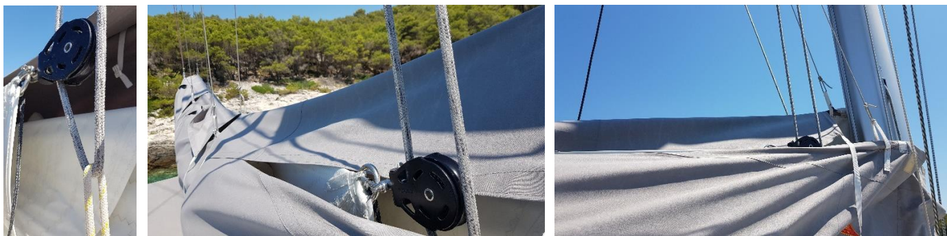
Zdjęcie 15. Zabezpieczenie fału grota kontrafałem i zamknięcie grota w lazy bag.
