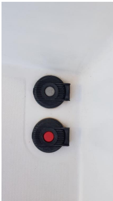
Zdjęcie 12. Kabestan elektryczny uruchamiany jest przyciskami przy podłodze w trybach: szybszym (czerwony) i wolniejszym pod koniec stawiania żagla (szary).
