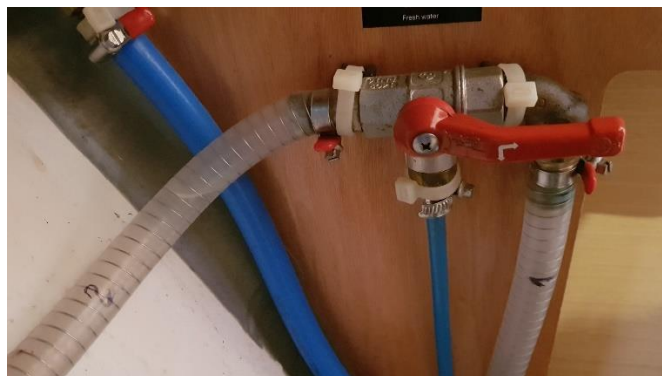
Zdjęcie 35. Panel odsalarki i przełącznik pomiędzy napełnianymi zbiornikami z odsalarki (od strony cienkiego niebieskiego przewodu): 1 na lewej burcie i 2 na prawej burcie (grubsze przezroczyste przewody prowadzące do zbiorników wody).
