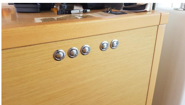
Zdjęcie 23. Okrągłe włączniki oświetlenia w salonie i kokpicie (po prawej ręce przy wejściu do salonu) oraz włączniki świateł bocznych w salonie razem z włącznikiem wysuwania telewizora (środkowy pionowy).
