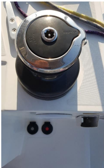
Zdjęcie 12. Kabestan elektryczny uruchamiany jest przyciskami przy podłodze w trybach: szybszym (czerwony) i wolniejszym pod koniec stawiania żagla (szary).
