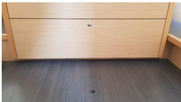
Zdjęcie 26. Kabina lewa rufowa, pod koją przy podłodze: hebel (czerwony kluczyk) do awaryjnego równoległego podłączenia akumulatorów rozruchowych silników z akumulatorami serwisowymi. Odłączanie akumulatora rozruchowego lewego silnika.
