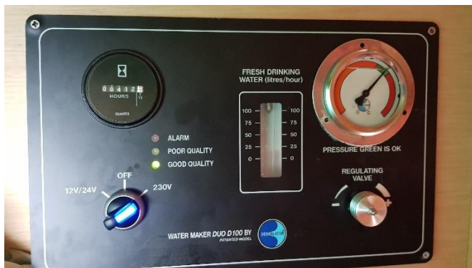
Zdjęcie 35. Panel odsalarki i przełącznik pomiędzy napełnianymi zbiornikami z odsalarki (od strony cienkiego niebieskiego przewodu): 1 na lewej burcie i 2 na prawej burcie (grubsze przezroczyste przewody prowadzące do zbiorników wody).
