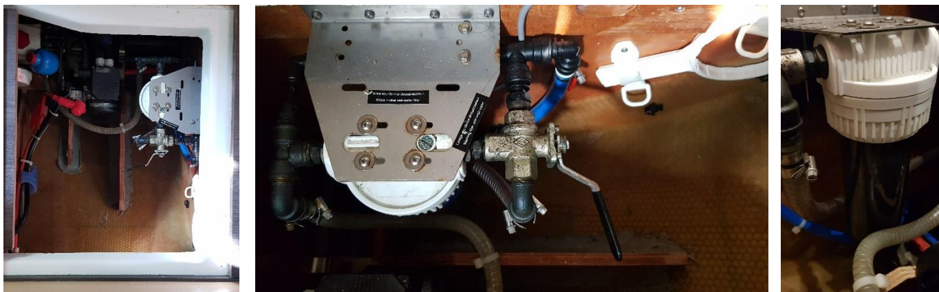
Zdjęcie 36. Widok odsalarki przy otwartej podłodze, trójnika oraz sznurkowego filtra wody w pojemniku z okrągłym kluczem służącym od otwarcia tego pojemnika przy ew. wymianie filtra.
